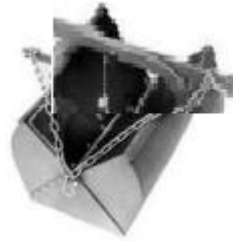
Figure 15. Benne « Van Veen »
