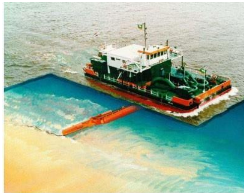
Figure 5. Dragage à injection d'eau
